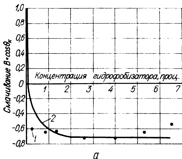
Рис. 9. Экспериментальные (1) и теоретические (2) изотермы смачивания на границе адсорбент — гидрофобизатор (метилсиликонат натрия):
